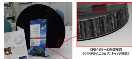
CFRPミラー 軽量なCFRPの光学ミラーへの転用
